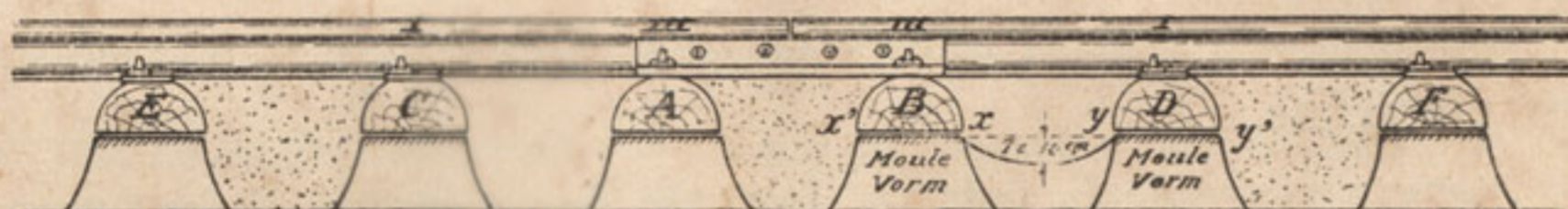
Fig. 107. — Entretien des voies par soufflage.
